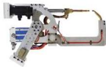
Dos electrodos que se cierran sobre la pieza a soldar.
