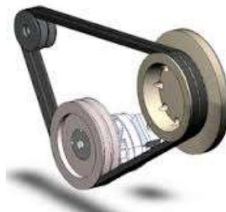
Para disminuir el deslizamiento, en vez de usar correas planas se usan correas de sección circular o trapezoidal (de tela o de goma), en este caso la polea tiene una cavidad en donde va alojada la correa.
