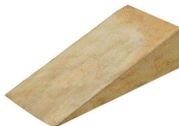
La cuña es un amplificador de fuerzas (tiene ganancia mecánica). Su forma de actuar es muy simple: transforma una fuerza aplicada en dirección al ángulo agudo ( $F$ ) en dos fuerzas perpendiculares a los planos que forman la arista afilada ( $F_1$  y  $F_2$ ); la suma vectorial de estas fuerzas es igual a la fuerza aplicada.
